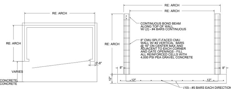
DUMPSTER PAD/ENCLOSURE DETAIL NOT TO SCALE
