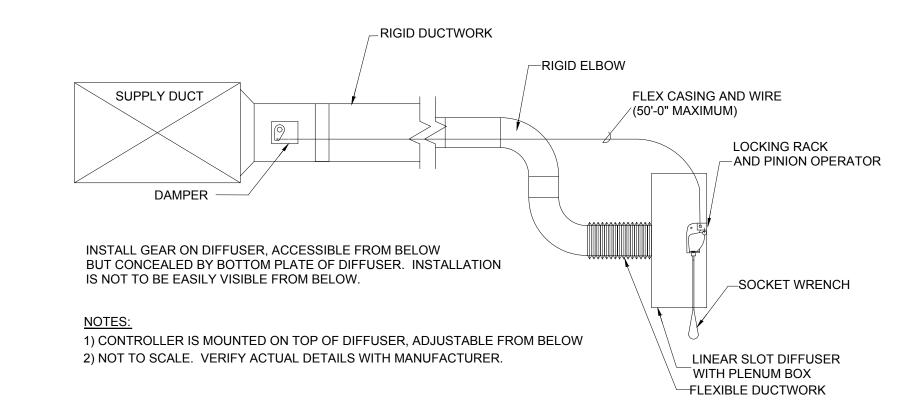
BALANCE DAMPER INSTALLED ON LINEAR DIFFUSER
